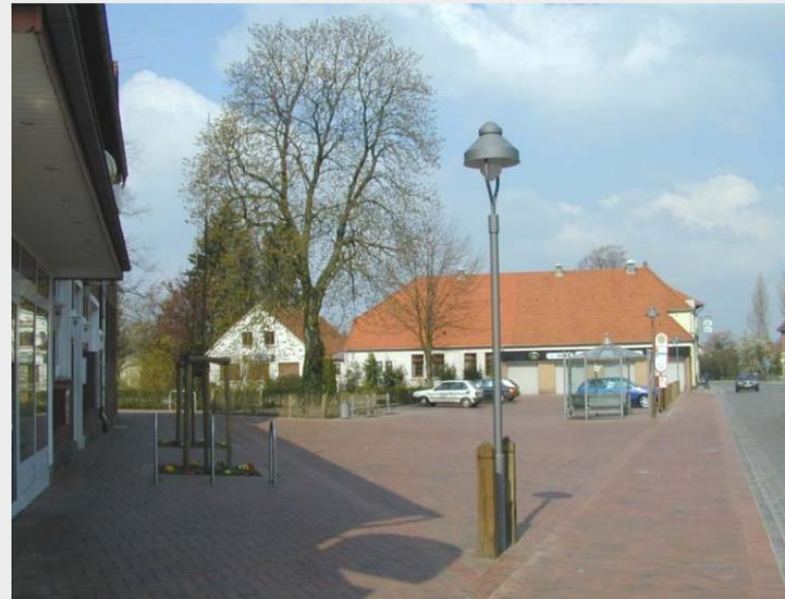
In der Ortsmitte wurde die Fahrbahn mit gerumpeltem Betonstein befestigt. Die Seitenräume wurden mit ortstypischen Klinkerpflaster gestaltet.
